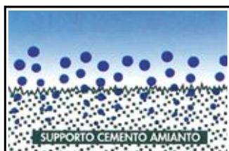
L'ottima penetrazione delle particelle fissa e isola le fibre di amianto
